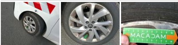
Jante alum. AVG, Griffe(s), Réparer/rempl. (montant forfaitaire)
