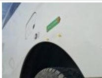
Panneau Latéral G, Bosse(s) et griffe(s), LI - Réparer et peindre (complet)
