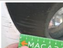
Coin de panneau ARD, Bosse(s) et griffe(s), LI - Réparer et peindre (complet)
