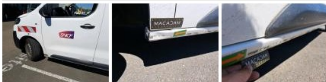
Pare-chocs AV, Cassé, E - Remplacer
