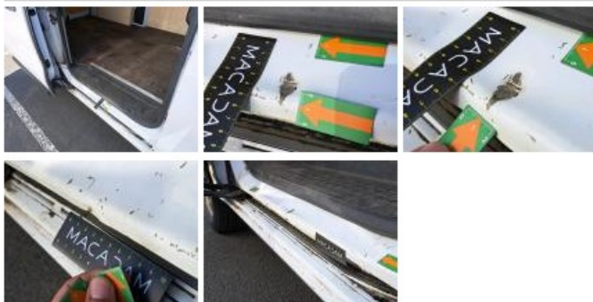
Bas de caisse int AVD, Bosse(s) et griffe(s), LI - Réparer et peindre (complet)
