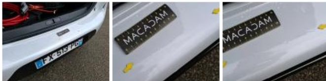
Pare-chocs AR, Mauvaise réparation, Peindre
