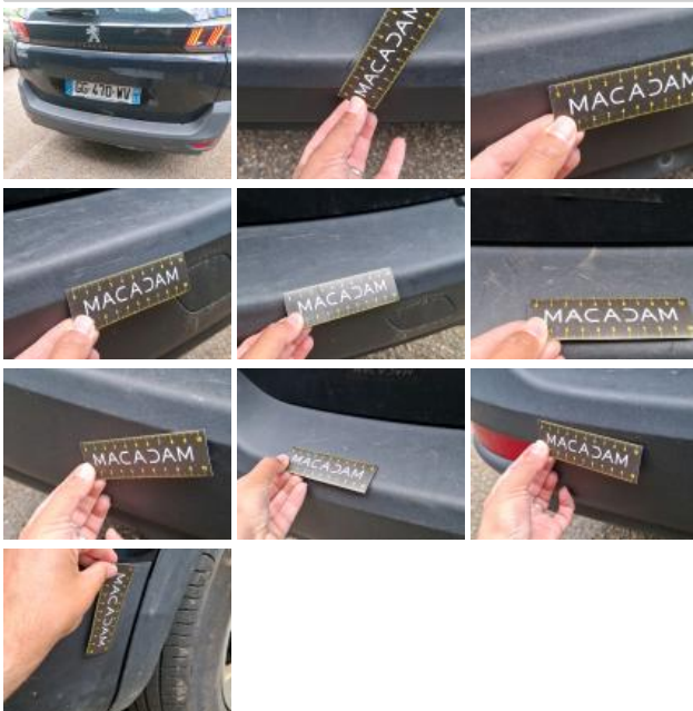
Coin pare-chocs ARD, Déformé / Forcé, Le - Remplacer et peindre
