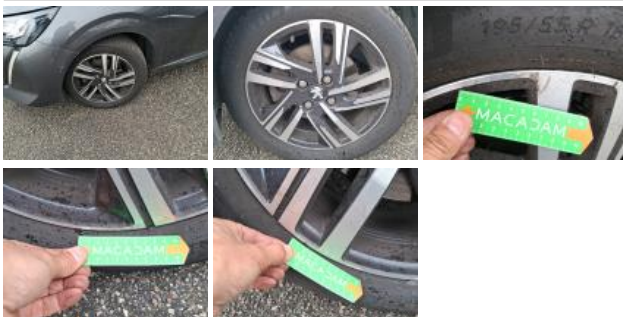
Pneu ARD, Déchirure, E - Remplacer
