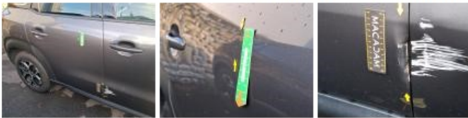
Porte AVD, Bosse(s) et griffe(s), LI - Réparer et peindre (complet)
