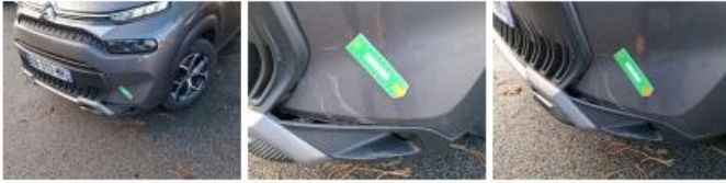
Grille de pare-chocs AV M, Déformé / Forcé, E - Remplacer
