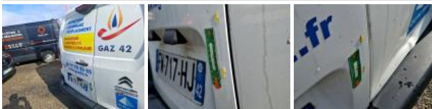
Joint de porte AR, Déchirure, E - Remplacer
