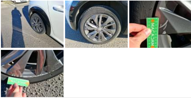
Pneu ARD, Déchirure, E - Remplacer
