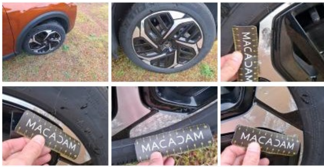
Jante alum. ARD bi-ton/polychrome, Dégâts chimiques, Acceptable
