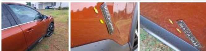
Moulure d'aile ARD, Griffe(s), Acceptable
