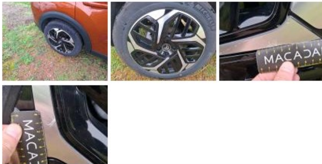
Jante alum. ARG bi-ton/polychrome, Dégâts chimiques, Acceptable
