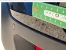
Pare-chocs AR, Mauvaise réparation, Peindre
