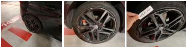
Jante alum. ARG, Griffe(s), Réparer/rempl. (montant forfaitaire)
