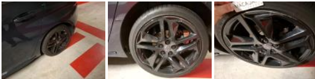
Jante alum. AVG, Griffe(s), Réparer/rempl. (montant forfaitaire)
