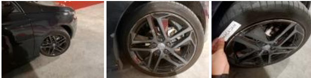
Jante alum. ARD, Griffe(s), Réparer/rempl. (montant forfaitaire)
