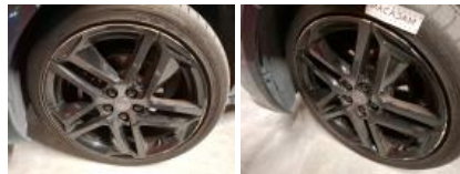
Aile AVG, Bosse(s) et griffe(s), LI - Réparer et peindre (complet)
