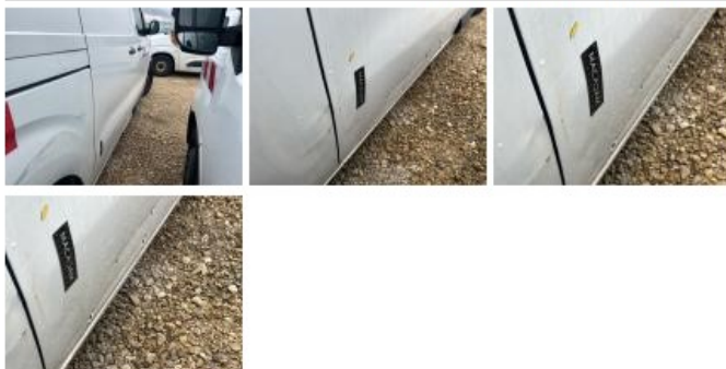
Moulure de panneau latéral D, Manque, E - Remplacer
