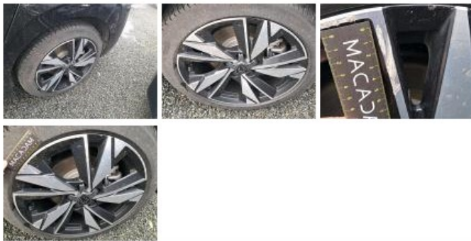
Pneu ARG, Déchirure, E - Remplacer
