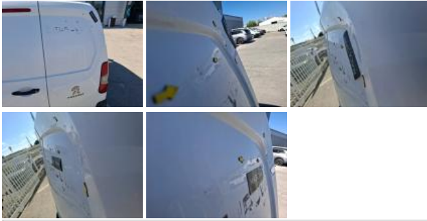
Coin pare-chocs ARG, Déformé / Forcé, E - Remplacer
