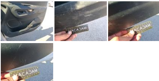
Bas de caisse ext G, Bosse(s) et griffe(s), LI - Réparer et peindre (complet)
