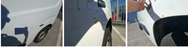
Moulure porte AVG, Déformé / Forcé, E - Remplacer
