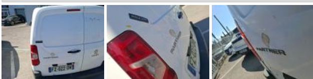
Porte de malle AR G, Bosse(s) et griffe(s), Le - Remplacer et peindre
