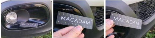
Phare antibrouillard D, Dégrafé, Dépose/Répose
