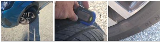
Pneu AVD, Hors tolérance, E - Remplacer
