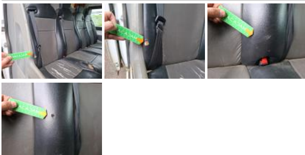
Revêtement dossier ARD, Déchirure, E - Remplacer
