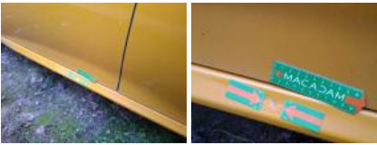
Bas de caisse ext G, Bosse(s) et griffe(s), LI - Réparer et peindre (complet)
