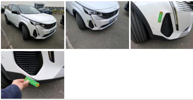
Spoiler AV, Griffe(s), Réparer/rempl. (montant forfaitaire)
