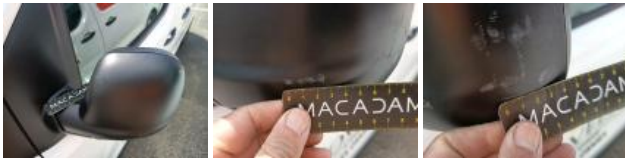
Moulure porte ARG, Manque, E - Remplacer
