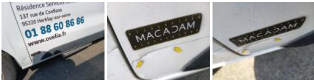
Moulure porte AVD, Dégrafé, Dépose/Repose
