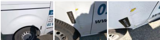
Porte coulissante D, Bosse(s) et griffe(s), LI - Réparer et peindre (complet)
