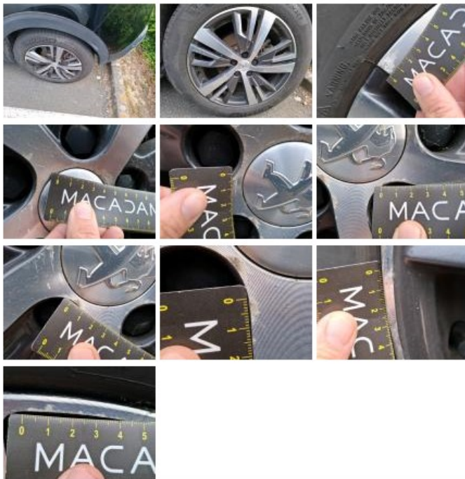
Pneu ARD, Hors tolérance, E - Remplacer
