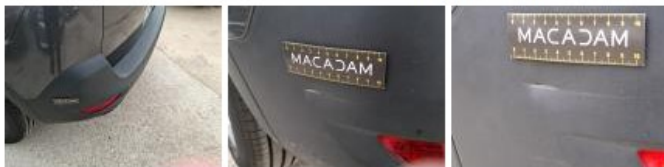
Catadioptr, Dégrafé, Dépose/Répose
