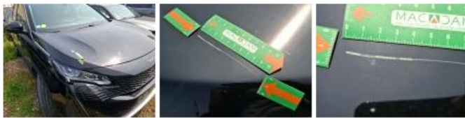
Pare-chocs AV, Griffe(s), Dépose/Répose
