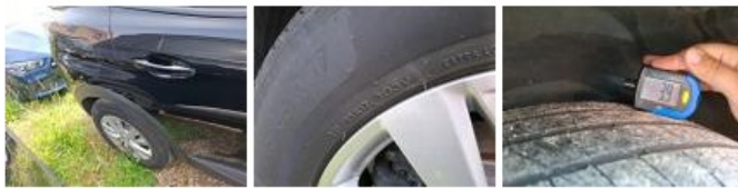
Pneu ARG, Hors tolérance, E - Remplacer
