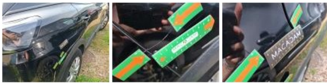
Boitier rétroviseur ext D, Griffe(s), Peindre
