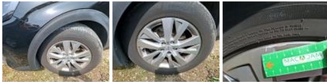
Pneu ARD, Hors tolérance, E - Remplacer
