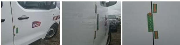
Joint de porte AR, Déchirure, E - Remplacer
