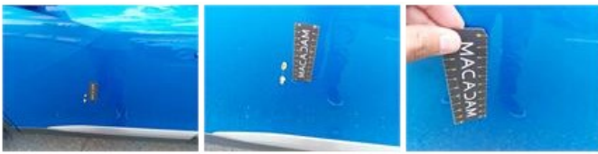
Moulure de pare-chocs AV, Griffe(s), Acceptable
