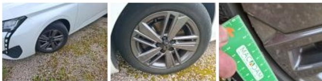
Pneu ARD, Hors tolérance, E - Remplacer
