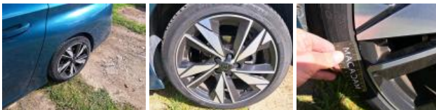
Pneu ARG, Déchirure, E - Remplacer
