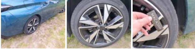
Pneu ARD, Déchirure, E - Remplacer
