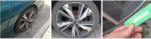
Bas de caisse ext G, Trou, LI - Réparer et peindre (complet)
