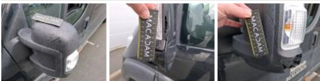
Moulure porte AVG, Cassé, E - Remplacer
