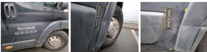
Moulure porte AVD, Griffe(s), Acceptable
