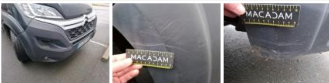
Pare-chocs AVD, Déformé / Forcé, LI - Réparer et peindre (complet)
