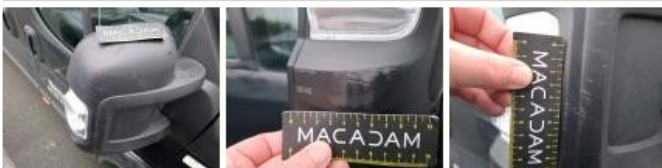
Feu ARD, Fêlure, E - Remplacer
