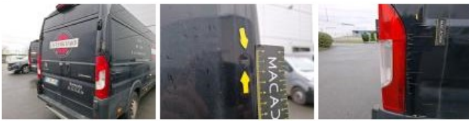
Moulure d'aile ARD, Griffe(s), Réparer/rempl. (montant forfaitaire)
