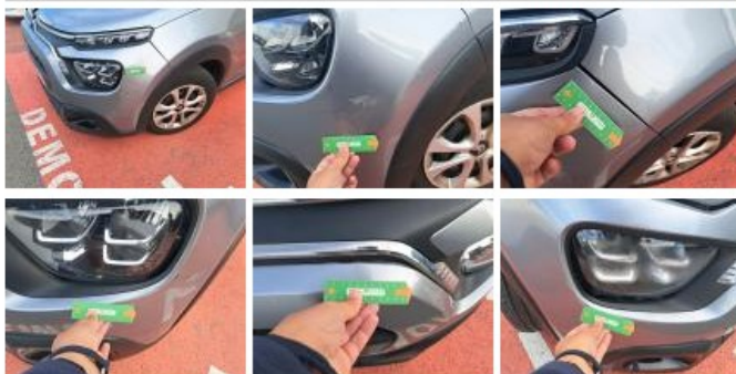
Pare-chocs AV, Griffe(s), LI - Réparer et peindre (complet)
