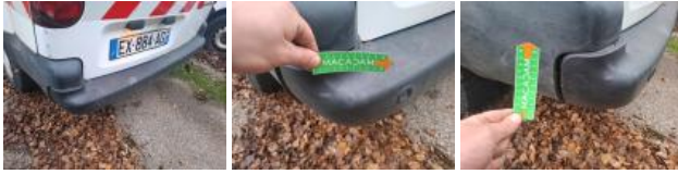
Pare-chocs AR, Déformé / Forcé, E - Remplacer
