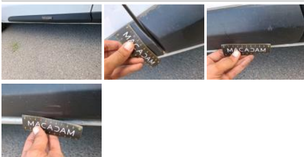
Moulure de panneau latéral G, Griffe(s), E - Remplacer
