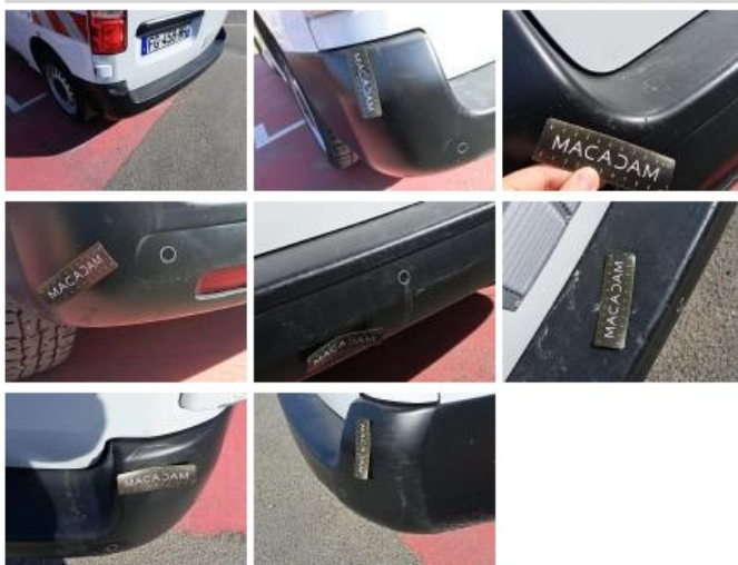
Pare-chocs AR, Griffe(s), E - Remplacer
