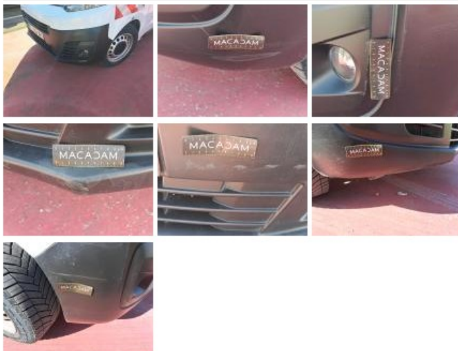
Phare antibrouillard D, Dégrafé, Dépose/Répose
