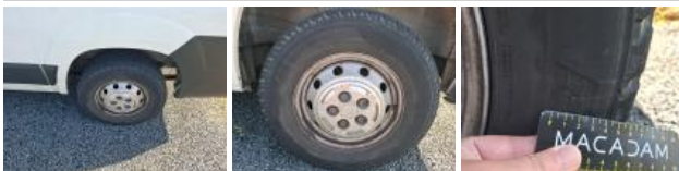
Pneu AVG, Déformé / Forcé, E - Remplacer
