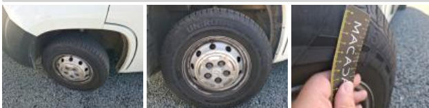
Pneu AVG, Déformé / Forcé, E - Remplacer
