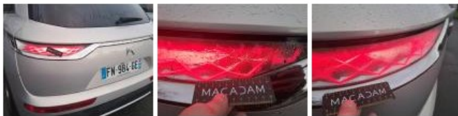
Feu ARG, Infiltration d'eau, E - Remplacer
