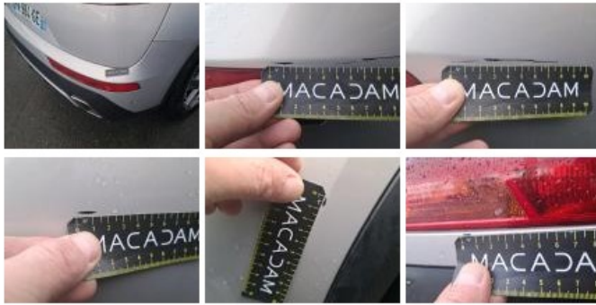
Feu ARG, Infiltration d'eau, E - Remplacer
