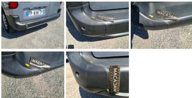
Pare-chocs AR, Déformé / Forcé, E - Remplacer
