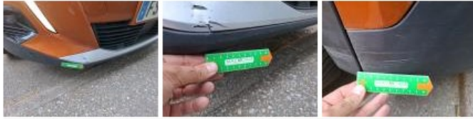
Moulure d'aile ARD, Dégrafé, Dépose/Répose
