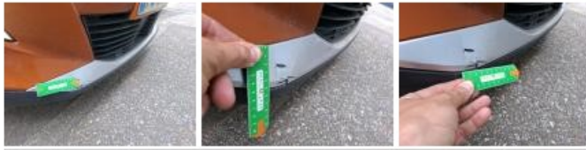
Moulure de pare-chocs AV, Griffes(s), E - Remplacer
