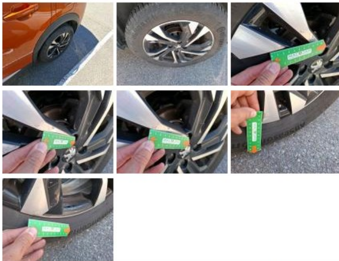
Pneu AVD, Hors tolérance, E - Remplacer
