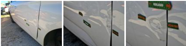
Bas de caisse ext D, Bosse(s), LI - Réparer et peindre (complet)
