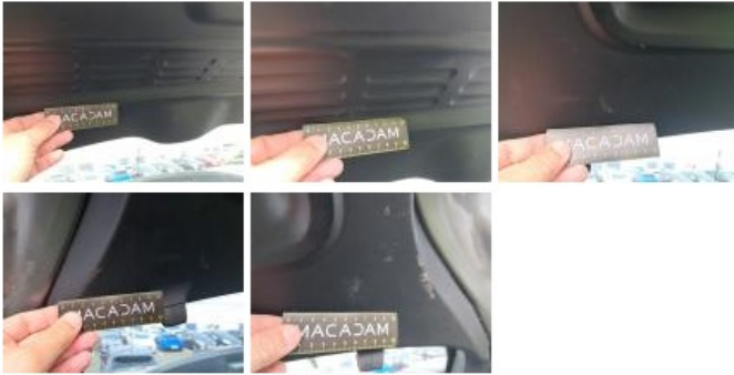
Joint de coffre/hayon, Déchirure, E - Remplacer
