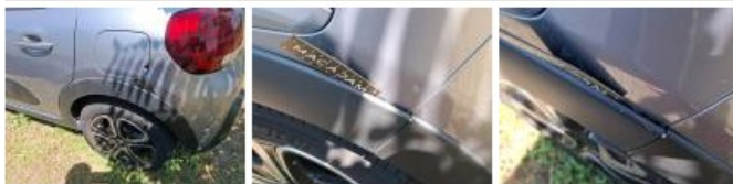
Moulure de pare-chocs AVG, Cassé, Le - Remplacer et peindre
