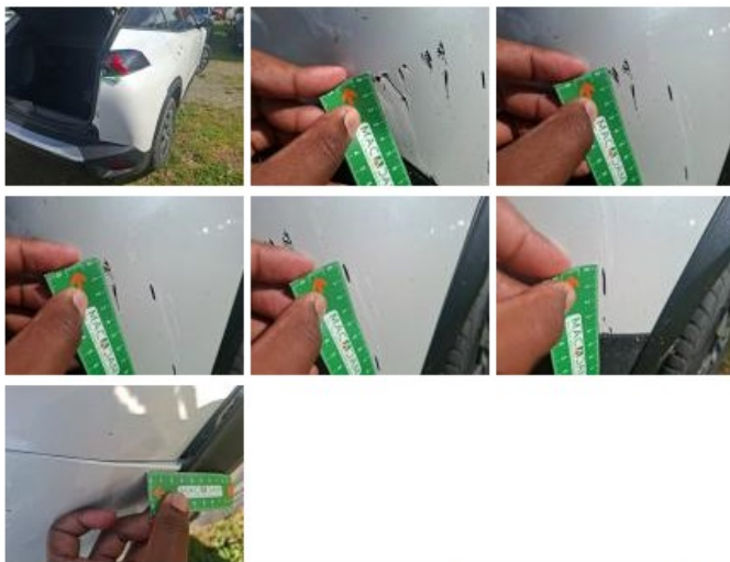
Monogramme marque AR, Manque, E - Remplacer
