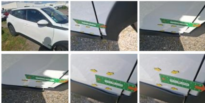
Moulure porte AVD, Griffes, Réparer/rempl. (montant forfaitaire)
