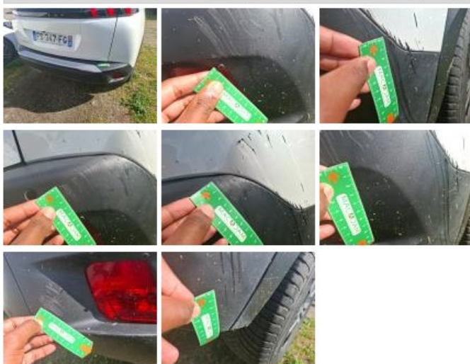
Pare-chocs AR, Griffes(s), E - Remplacer
