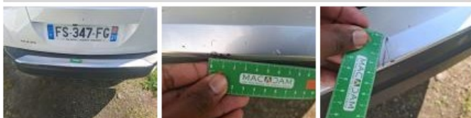
Pare-chocs AR, Griffes(s), E - Remplacer
