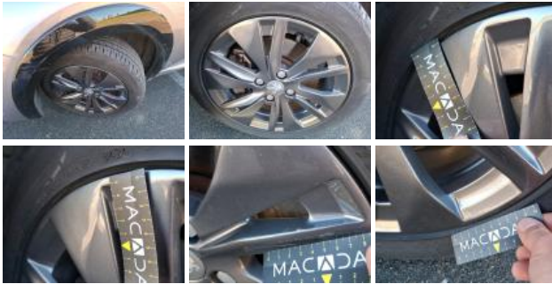
Jante alum. ARG, Mauvaise réparation, Réparer/rempl. (montant forfaitaire)
