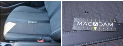
Revêtement assise siège AVD, Déchirure, Réparer/rempl. (montant forfaitaire)
