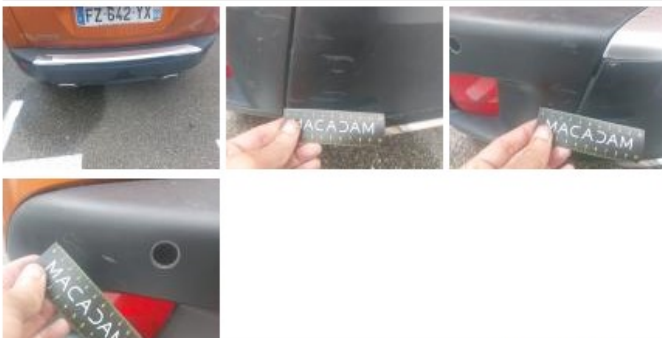
Garnit. couvercle AR, Griffe(s), Réparer/remplacer (montant forfaitaire)
