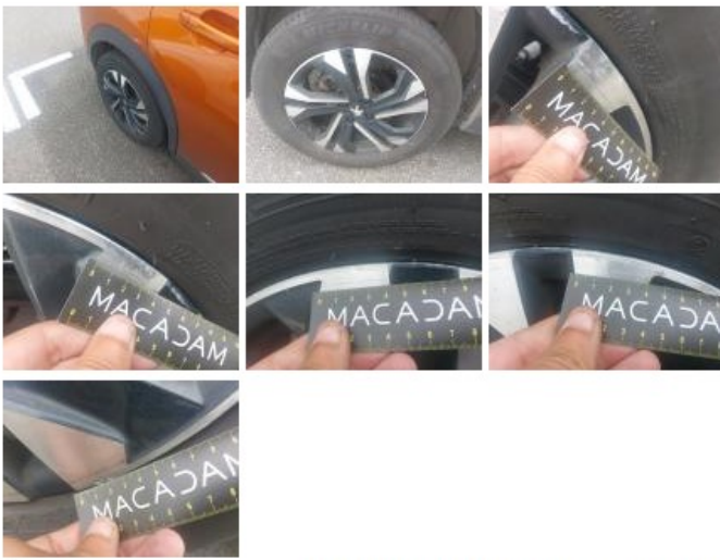
Jante alum. AVD bi-ton/polychrome, Griffe(s), Réparer/remplacer (montant forfaitaire)
