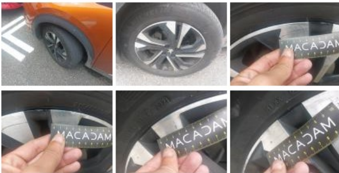
Jante alum. ARG bi-ton/polychrome, Griffe(s), Réparer/remplacer (montant forfaitaire)
