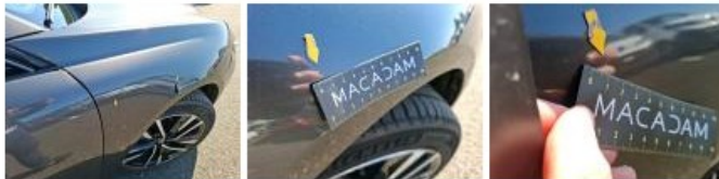
Aile AVD, Mauvaise réparation, Peindre
