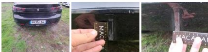
Joint de coffre/hayon, Déchirure, E - Remplacer
