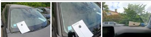
Pare-brise, Fêlure, E - Remplacer
