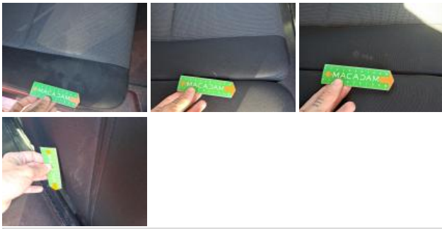
Revêtement assise siège AVD, Brûlé, E - Remplacer
