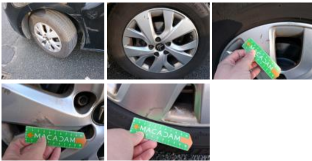
Jante alum. ARG, Griffes, Réparer/rempl. (montant forfaitaire)
