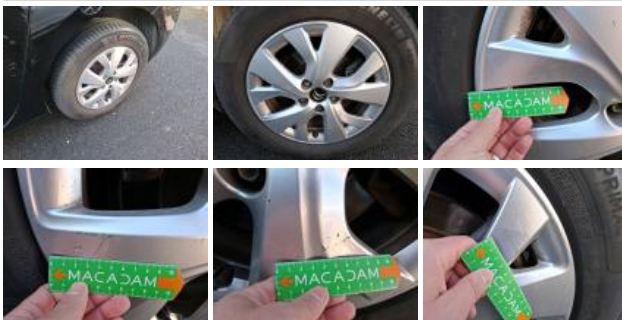
Jante alum. ARD, Griffes, Réparer/rempl. (montant forfaitaire)
