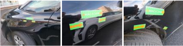
Boîtier rétroviseur ext G, Griffe(s), Peindre
