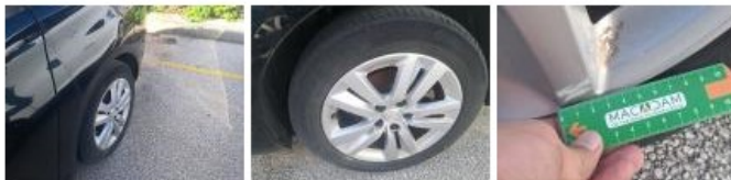
Pneu ARD, Hors tolérance, E - Remplacer
