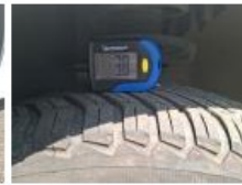
Pneu AVD, Hors tolérance, E - Remplacer
